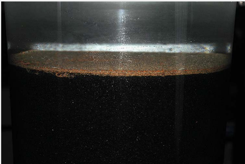
Fig. 7 Ablagerungen auf der Aktivkohleoberfläche nach dreimonatigem Betrieb Dépôts sur la surface des charbons actifs après trois mois de test
