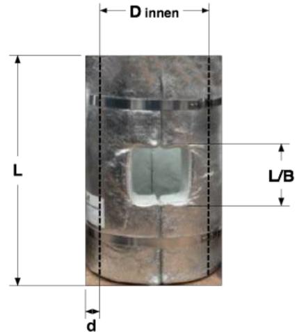
Für die Herstellung der Dämmkappen dürfen keine Isolationsmatten, Stützkarton oder Stützbleche verwendet werden.
