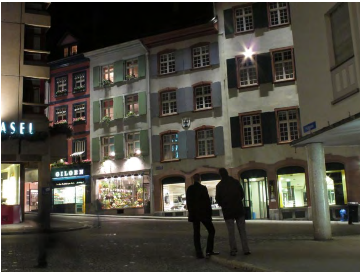
Spalenberg 2,4 und 6 mit Fassadenbeleuchtung (schlanke LED Schiene im Vordachbereich)
